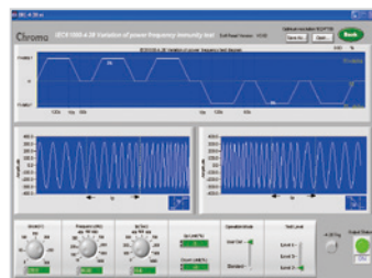
頻率變動IEC標準測試
