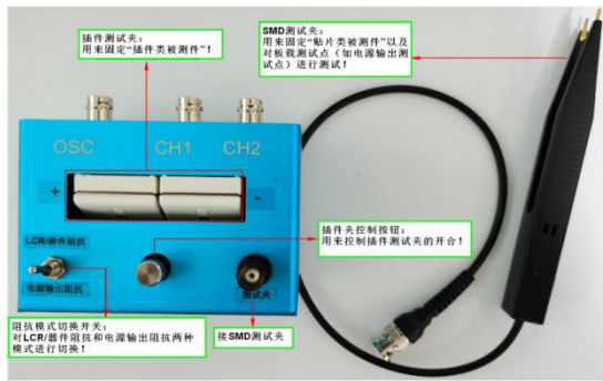
X618A-FIX 测试夹具示意图
