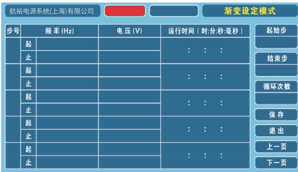
渐变设置页面可设置所需电压、频率、运行时间、初始步、结束步
